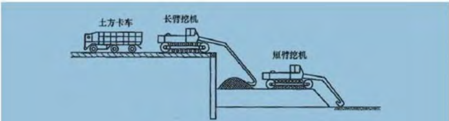
图1K413023-2 浅层接力挖土示意图
