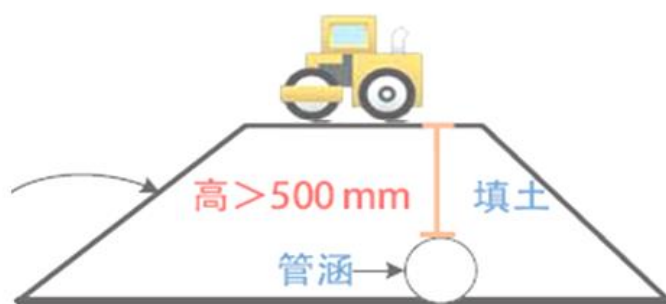
管涵回填盖板涵回填
