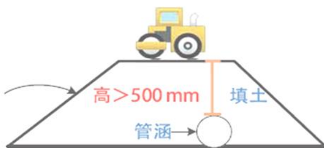
管涵回填盖板涵回填
