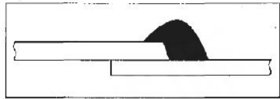
图 2K316013-3 单缝挤压焊接焊缝示意图
